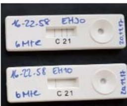
Bild 2: Teststreifen mit einem positiven Resultat: beide Markerbakterien konnten nachgewiesen werden (oben). Teststreifen mit einem negativen Resultat: nur die Kontroll-Bande ist sichtbar, kein Markerbakterium wurde nachgewiesen (unten).
